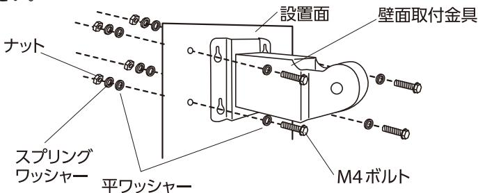
壁面取付金具寸法図を参照し、壁面にアンカーボルト用の穴を開けます。M5アンカーボルト(4本)[ナット(4個)、スプリングワッシャー(4枚)、ワッシャー(4枚)]を使用して本体を固定します。(別途お買い求めください)
